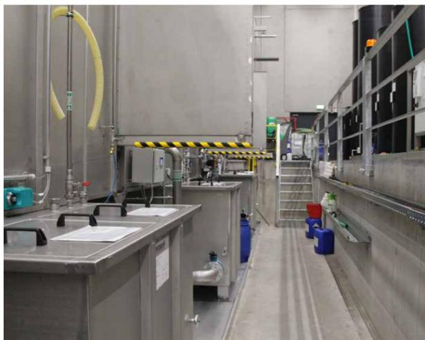
Die zu beschichtenden Teile müssen vor der Beschichtung von allen Verunreinigungen wie Fetten, Ölen, Schmutz etc. befreit werden. Dies dient dazu, eine bessere Abstimmung zwischen Untergrund und Lack zu erzielen. Eine unzureichend durchgeführte Vorbehandlung kann zu Kratern im Lackfilm führen. Wir garantieren ein einwandfreies Endprodukt.
